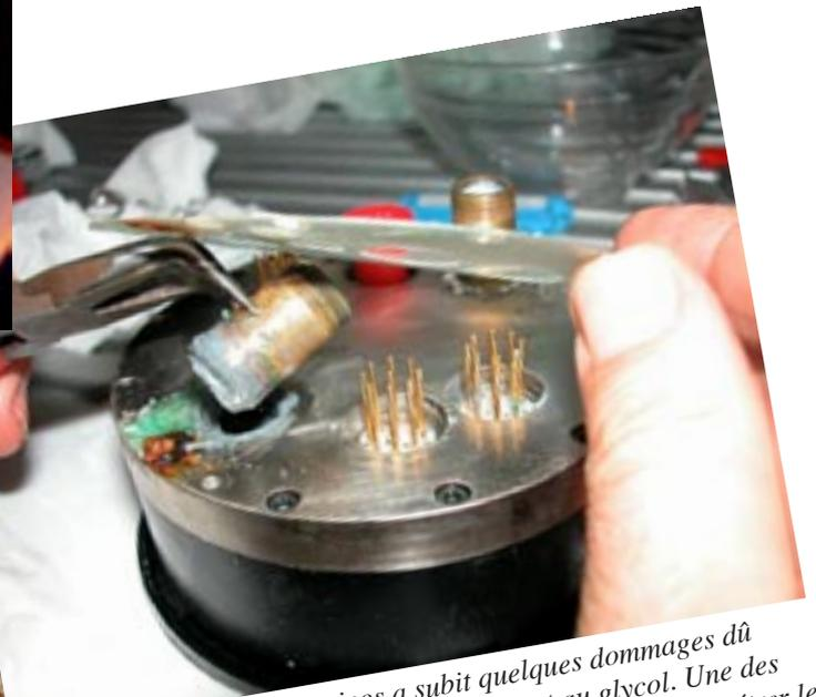
La caméra du spectro musicos a subi quelques dommages dû à une fuite dans le circuit de refroidissement au glycol. Une des pièces du circuit s'est complètement dessoudé, laissant pénétrer le liquide sur les circuits imprimés de l'électronique de la CCD.
