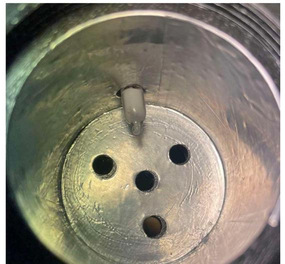
Dans le bloc principal, insérer les 2 fils de la luciole dans les trous prévus à cet effet. Les 2 fils devront plus tard être garnis d'une gaine thermo-rétractable pour éviter tout court circuit.
