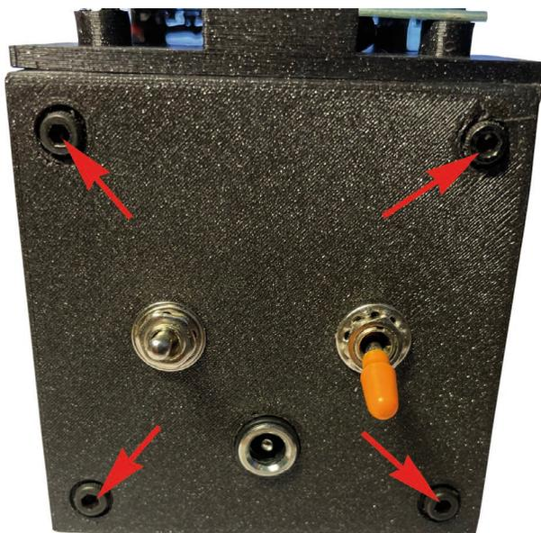
Visser le capot arrière sur le bloc principal avec 4 vis M3 de 8 mm de longueur.
