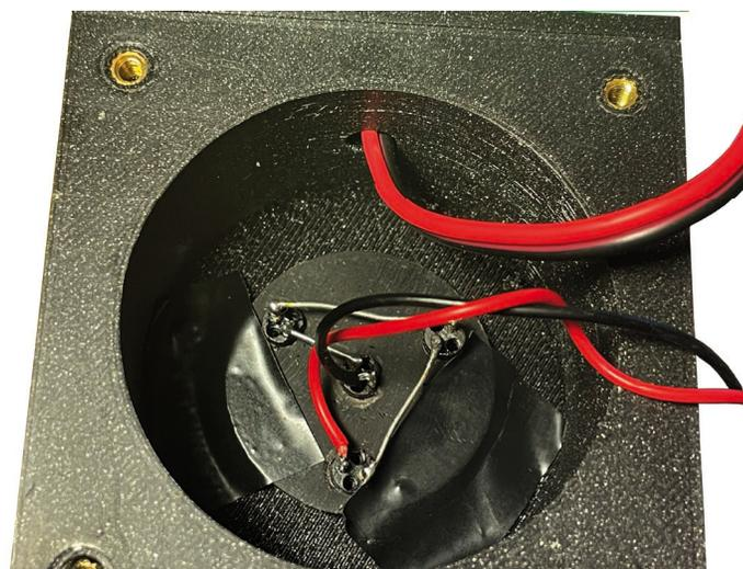
Sur le support des 4 douilles des ampoules Xenon, relier les douilles en série tel que le montre la photo puis insérer le support dans le bloc principal. Afin de maintenir en place ce support, vous pouvez utiliser du ruban adhésif d'électricien pour bien appliquer le support au fond du bloc principal.
