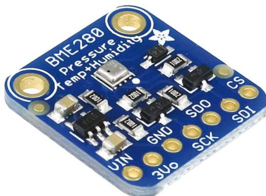
Ce capteur permet à lui seul de mesurer la température, le degré d'humidité et la pression.
