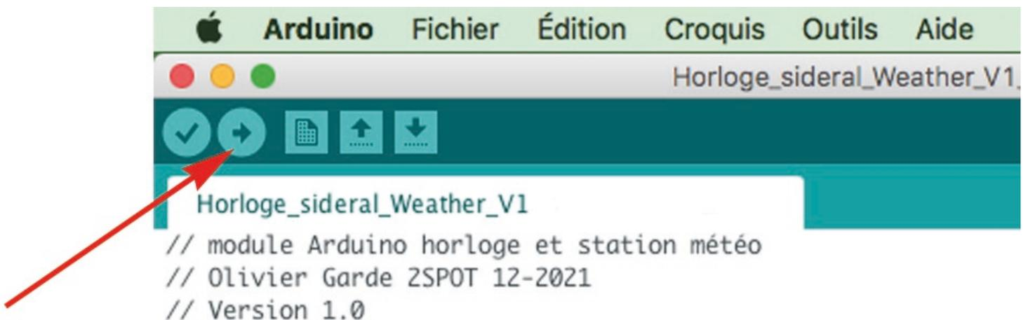
Le programme est ainsi téléversé dans la carte Arduino et dans la fenêtre ou figure les lignes de codes du programme, un message s'affiche en bas indiquant soit des erreurs, soit que le téléchargement est effectué.
