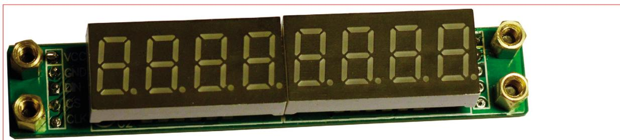
Puis monter les 2 afficheurs sur le châssis. Bien repérer le montage de l'afficheur comportant le condensateur qui doit être positionné à droite du boîtier lorsque que l'on regarde de face (affichage du temps sidéral local).
