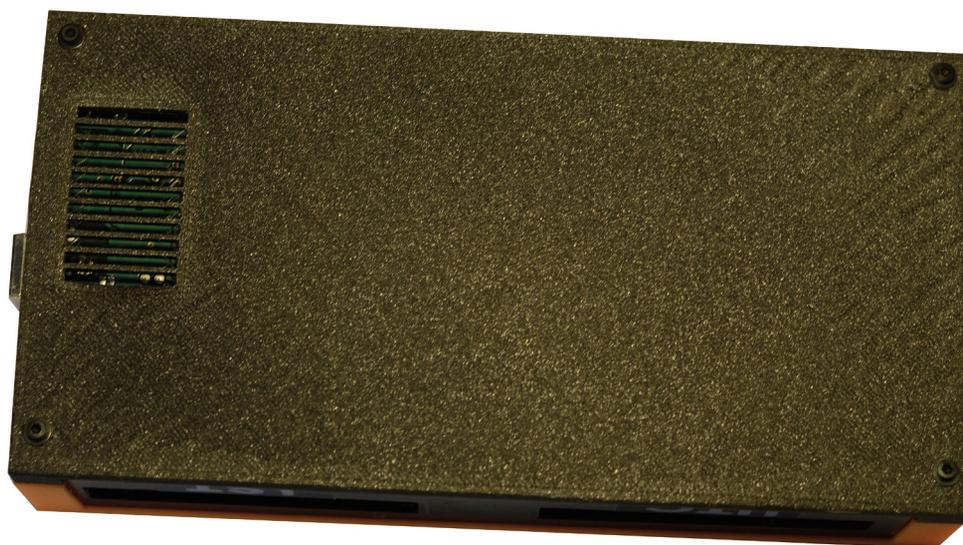
On termine l'assemblage en fixant 4 vis M2 de 16mm de long avec 4 rondelles tel que le montre la photo ci dessus sans trop forcer sur le serrage des vis.
