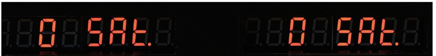
Lorsque le nombre de satellites est suffisant pour afficher l'heure UTC, l'afficheur bascule ensuite automatiquement sur cet affichage. Cela peut prendre plusieurs minutes voir pas du tout si le module n'arrive pas à capter des satellites. Dans ce cas il est préférable d'utiliser une antenne extérieur tel que décrit au début de cette documentation.
