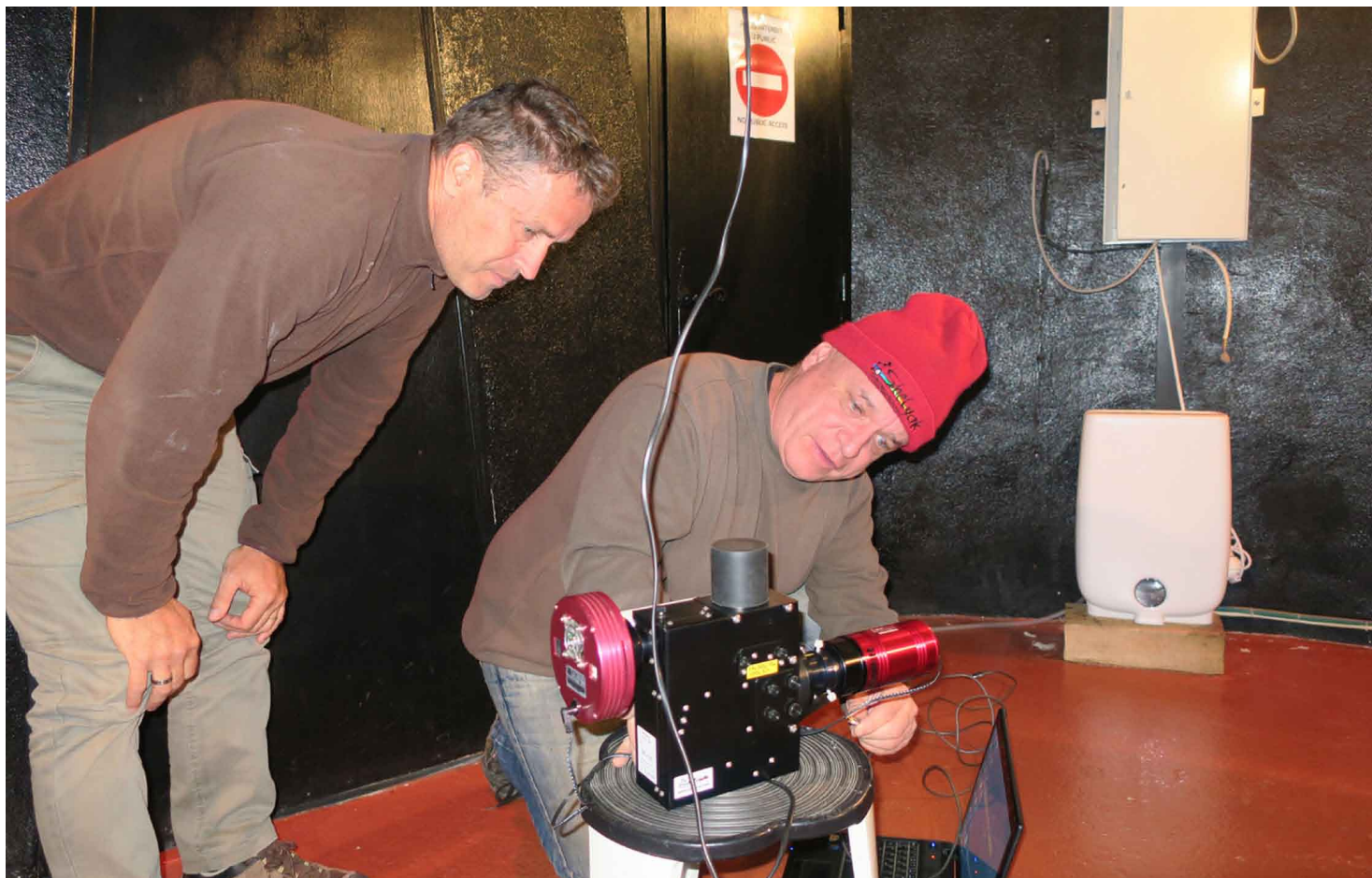
Réglage du spectrographe LISA avant fixation sur le télescope
